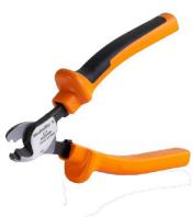
Tagliacavi per conduttori di diametro esterno fino a 8 mm, 12 mm, 14 mm e 22 mm. La speciale geometria della lama consente il taglio netto e pulito di conduttori in rame e alluminio con il minimo sforzo. I tagliacavi (da KT 8 a KT 22) sono disponibili anche con isolamento protettivo verificato VDE e GS per una tensione max. di 1.000 V a norma EN/IEC 60900.
